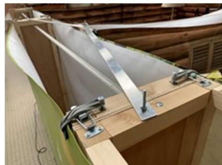
D – Fixation des barres de renfort « U » (étape 14)
